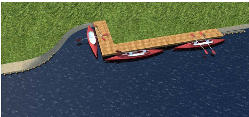
Rys. 20. Nabrzeże przystani dla kajaków wyposażonej w slip i pomost
