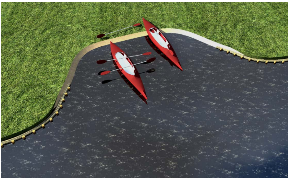
Rys. 21. Przykład prostej przystani dla kajaków w postaci odpowiednio ukształtowanego w formie slipu brzegu rzeki / jeziora
