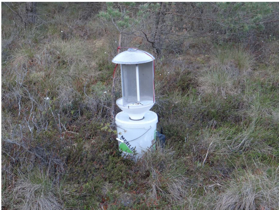
Fot 26. Samolówka do wabienia owadów wykorzystywana w trakcie badań.
